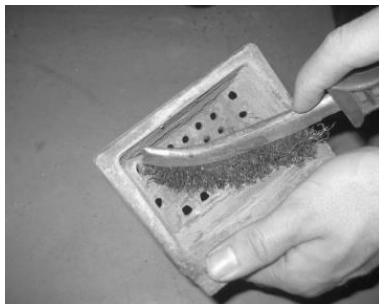
Figura 21 – Limpeza do cesto de queima
