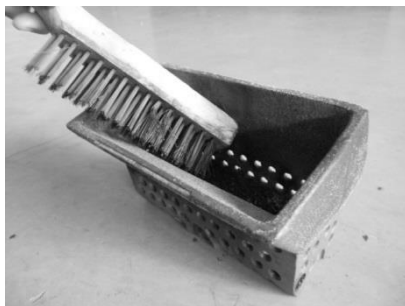
Figura 19 – Limpeza do cesto de queima
