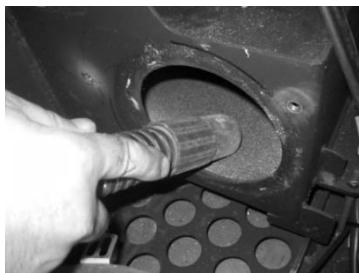
Figura 23 – Aspirar a zona de passagem do ar
