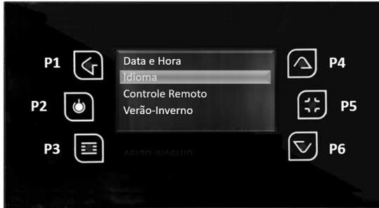
Dentro deste submenu, com P4 e P6 selecionar o idioma pretendido e voltar a pressionar a tecla P3 para validar.
