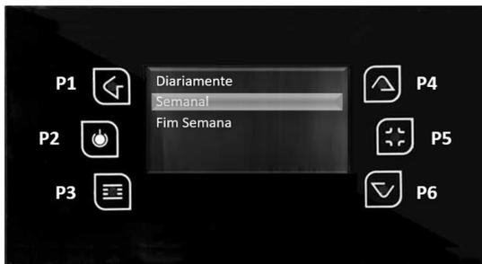
Deve pressionar P3 e este campo passa a estar no modo editável, a piscar. Pressionando P4 e P6 selecciona a hora desejada e de seguida use a tecla P3 para salvar. Deve repetir este processo para a hora em que o equipamento deve desligar, com as teclas P4 e P6. Por fim deve activar o intervalo com a tecla P5, e assim aparecerá um sinal de visto do lado direito do intervalo.
