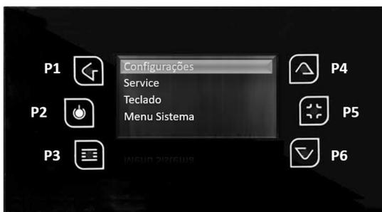
Com a tecla P6 seleccione o submenu Verão-Inverno e para validar a entrada neste submenu a tecla P3.
