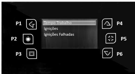
Com as teclas P4 e P6, seleccione o submenu que deseja consultar e pressione P3 para validar. Para voltar ao menu Service pressione P1.
