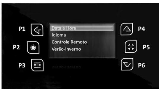
Já no menu Data e Hora, seleccionar Hora, com as teclas P4 e P6, e pressionar a tecla P3, aparecerá a hora em modo editável, a piscar, com P4 e P6 seleccionar a hora correta e pressionar P3 para validar.
