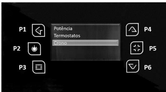
Seguidamente deve entrar no submenu Programa, usando a tecla P6 para seleccionar e P3 para validar a escolha.
