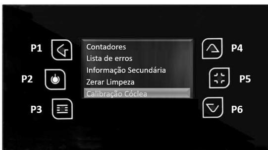
Neste submenu com as teclas P4 e P6 pode ajustar a quantidade de pellets a alimentar, entre -7 (-14%) e 7 (+14%). Para voltar ao menu Service pressione P1.
