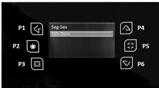
Deve pressionar P3 e este campo passa a estar no modo editável, a piscar. Pressionando P4 e P6 seleccione a hora desejada e de seguida use a tecla P3 para salvar. Deve repetir este processo para a hora em que o equipamento deve desligar, com as teclas P4 e P6. Por fim deve activar o intervalo com a tecla P5, e assim aparecerá um sinal de visto do lado direito do intervalo.
