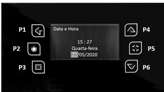
Para editar o Mês deve usar as teclas P4 e P6 para seleccionar este campo e de seguida P3, aparecerá o mês em modo editável, com P4 e P6 seleccionar o mês desejado e voltar a pressionar P3 para validar.
