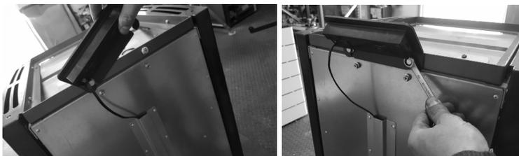
**Figura 15 – Fixação do display**
