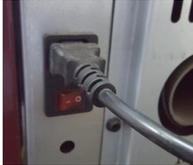
**Figura 8 – Ficha ligação corrente elétrica**
