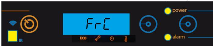
**Nota:** quando o comando está activo os LEDs de power e alarme ligam de forma intermitente com a cor verde.
