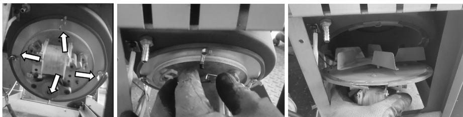
a) Remoção parafusos
