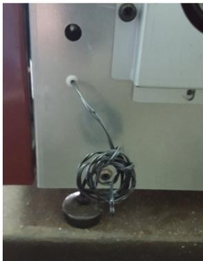
**Figura 9 – sonda de temperatura ambiente**
