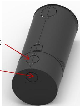
O kit de entrada de ar externo, deve ser colocado na zona inferior do equipamento, como mostra a Figura 9, para isso deve desapertar os 3 parafusos que fixam a base ao equipamento e aplicar o kit de entrada de ar externo com as 4 porcas que vem na embalagem.
