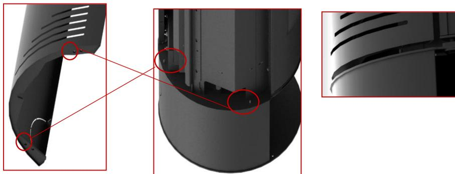
**Figura 13 - Centramento da capa lateral com o equipamento**
