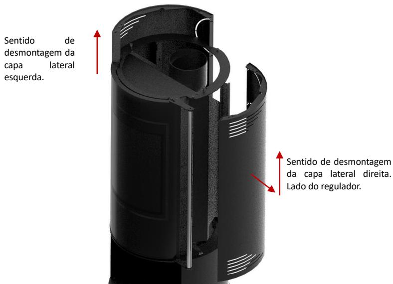
4- Quando estiver para montar em capas laterais ter em atenção o seguinte, a zona inferior das capas tem 2 furos, esses furos, devem coincidir com os parafusos que vem na máquina, poderá verificar na Figura 13.
