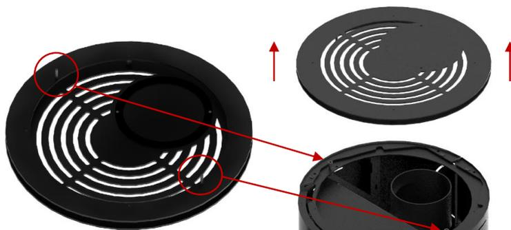
2- Desapertar os parafusos na parte superior das capas, como mostra a Figura 11, de modo que as capas fiquem livres.
