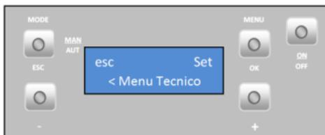
Carregar em Ok e começa a piscar "A", com as teclas "+" e "-" seleccione a letra pretendida, carregue em ok para confirmar e "00" começará a piscar, com as tecla "+" e "-" seleccione o nº pretendido, confirme em ok e entra no menu "Configuração".
