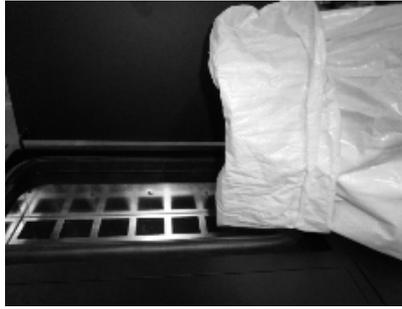
**Figura 16 – Reabastecimento do depósito de pellets**
