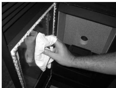
Figura 30 – Limpeza do vidro: a) Aplicar líquido no pano; b) Limpar o vidro com o pano
