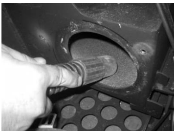
Figura 28 – Aspirar a zona de passagem de ar
