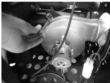
Figura 27 – a) Retirar os parafusos; b) Retirar o extractor
