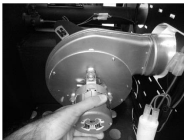
Figura 27 – a) Retirar os parafusos; b) Retirar o extractor
