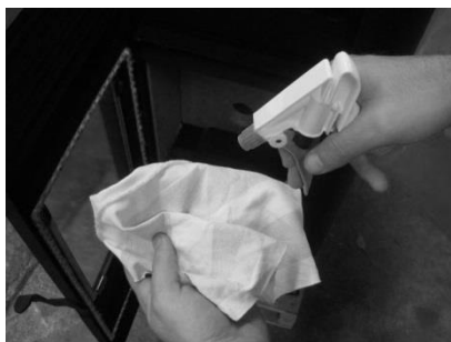
Figura 30 – Limpeza do vidro: a) Aplicar líquido no pano; b) Limpar o vidro com o pano
